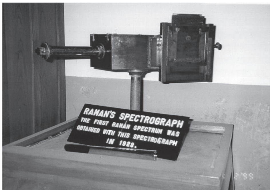
شکل ۱. پروفیسور ج. و. رامان بخاطر کارهایی که در زمینه پراکنش نور و کشف اثر رامان در انجمن ترویج علوم هند انجام داد در ۱۹۳۰ موفق به دریافت جایزه نوبل در فیزیک شد. او از این دستگاه ساده و ابتکاری برای کشف این اثر سود جست.
